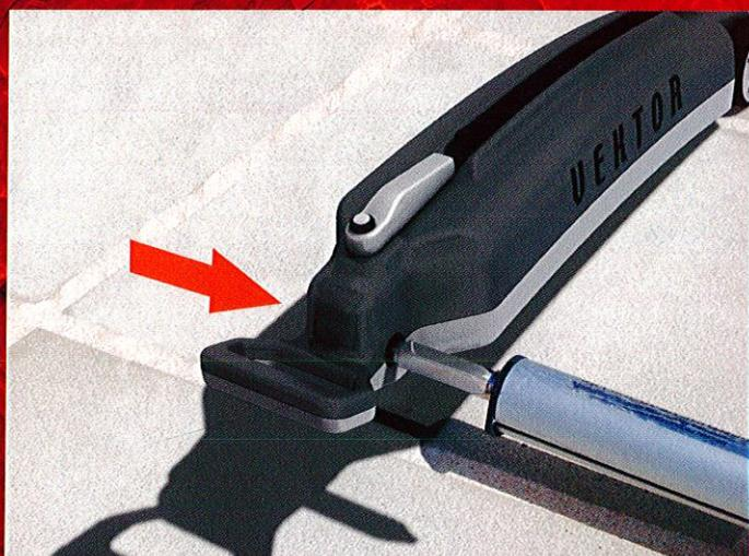
Positionnez VEKTOR devant la sortie carrée du tube d'enroulement, à droite ou à gauche de la couverture
